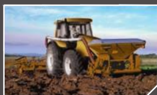
フロント用大型肥料ホッパーと 播種機のコンビネーション
