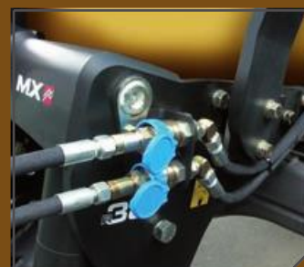
外部油圧ライン
